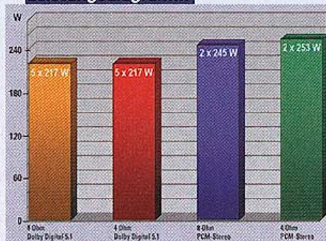
Fast identische Leistungsergebnisse liefert die M25 sowohl an 8 als auch an 4 Ohm im Mehrkanal- bzw. Stereobetrieb
